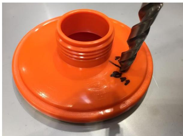
Используя подходящее сверло, просверлите в крышке бака-ферментера отверстие диаметром 10,5 мм (сверло 10 мм, если 10,5 мм не доступно), для подключения провода датчика температуры, расположенного на прикрепленном гидрозатворе. Рекомендуем предварительно просверлить отверстие сверлом значительно меньшего диаметра, особенно, если крышка изготовлена из нержавеющей стали.
