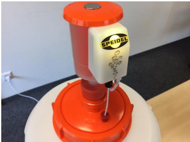
Важно обеспечить герметичность соединения для выхода газов брожения исключительно **ТОЛЬКО** через гидрозатвор. Подключите кабель питания USB к сети через зарядное устройство и убедитесь, что влага не может просочиться вниз по кабелю в зарядное устройство. Светодиод должен кратковременно загореться пурпурным цветом, а затем переключиться на желтый (режим конфигурации).
