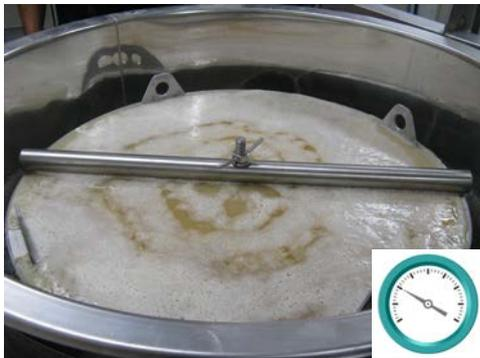
Нажмите кнопку *Подтвердить* для продолжения автоматического режима. Слегка окрашенная вода поднимается и переливается. Цикл начался. Следующие фазы затирания выполняются полностью автоматически, как запрограммировано. Периодически система останавливает насос для изменения положения солода. Дисплей отображает фактическую и целевую температуры и реальное время. Установите скорость насоса поворотным потенциометром, обеспечивая давление рециркуляции 0,2 бар (уровень скорости 8-9).
