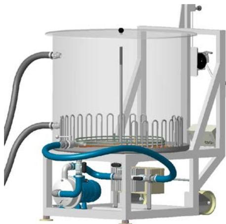
Подключите шланги и переключите краны, как показано на рисунке слева. Выбор низкой скорости насоса (установлен на 6-8) обеспечивает постоянное вращение сусла в котле. Внимание: насос снова перезапускается только при 86°C. Медленное вращение сусла улучшает процесс охлаждения. На охлаждение сусла от 100°C до 25°C (при использовании ледяной воды) требуется ок. 50 мин / 120 мин.
