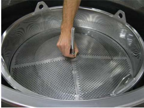
Когда температура затирания достигнута, раздаётся звуковой сигнал; Нажмите *Подтвердить*, чтобы подтвердить его. Затем вставьте солодовую корзину (уплотнением вниз).
