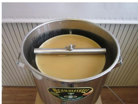
Нажмите кнопку *Подтвердить* для продолжения автоматического режима. Слегка окрашенная вода поднимается и переливается. Цикл начался. Следующие фазы затирания выполняются полностью автоматически, как запрограммировано. Периодически система останавливает насос для изменения положения солода. Дисплей отображает фактическую и целевую температуры, а также целевое и фактическое время работы каждого этапа варки.
