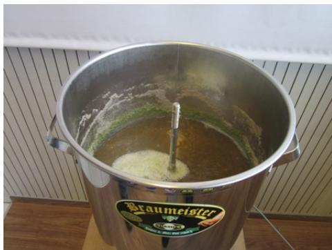
Продолжайте, нажав кнопку *Подтвердить*, чтобы начать процесс кипечения хмеля. Не закрывайте крышку. Избегайте пенообразования. Добавить первые партии хмеля 10 г / 20 г / 50 г через 10 мин после начала кипячения. Не закрывайте крышку во время процесса варки хмеля. Добавьте количество выпаренной воды или проверьте плотность сусло. Добавьте последнюю порцию хмеля за 10 мин до окончания кипения.
