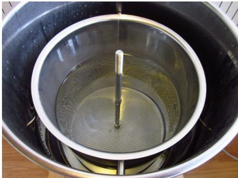
Когда температура затирания достигнута, раздаётся звуковой сигнал; Нажмите *Подтвердить*, чтобы подтвердить его. Затем вставьте солодовую корзину (уплотнением вниз). Убедитесь, что уплотнение центрировано на корзине и полностью вставлено в основание емкости. Вставьте фильтр-пластину в нижний край (втулкой вверх). Затем вставьте мелкое сито.
