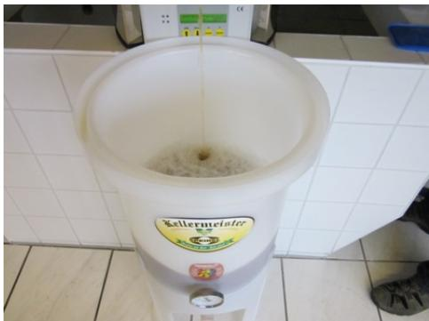
Вылейте сусло в ферментор емкостью 12 л /30 л /60л. Используйте дезинфицирующее средство для мойки емкости. Осадок со дна котла не должен попасть в ферментор. Добавьте 11г сухих дрожжей в сусло для брожения и запечатайте с помощью гидрозатвора, заполненного дезинфицирующим средством.
