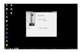
Подключите модуль (порт на стороне модуля) к ПК с помощью USB-кабеля. Подождите, пока операционная система автоматически не найдёт подходящий драйвер и не установит его. Затем подключите Braumeister к сети. Запустите Обновления ПО и перенесите последнюю версию прошивки в контроллер. Отключите Braumeister и отсоедините USB-кабель. Последняя версия теперь находиться в контроллере пивоварни.
