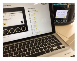
На экране изображение контроллера Braumeister. Вы можете участвовать в процессе варки, запустив рецепт или вручную включить / выключить нагреватель или насос. Изменение настроек производится на устройстве вручную, а рецепты изменяются и разрабатываются с помощью MySpeidel. В экстренных случаях программу можно остановить или завершить в онлайн режиме.
