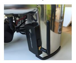
Извлеките WI-FI модуль из коробки и установите его на основание пивоварни Braumeister. Вставьте кабельный разъем в свободное гнездо на обратной стороне контроллера Braumeister и затяните его гайкой (также как подключен датчик температуры).
